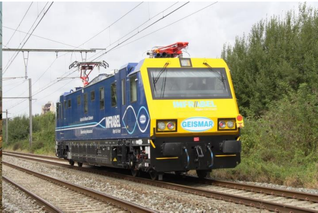
Dieselmotorwagen Infrabel EM 201 Bovenleiding
