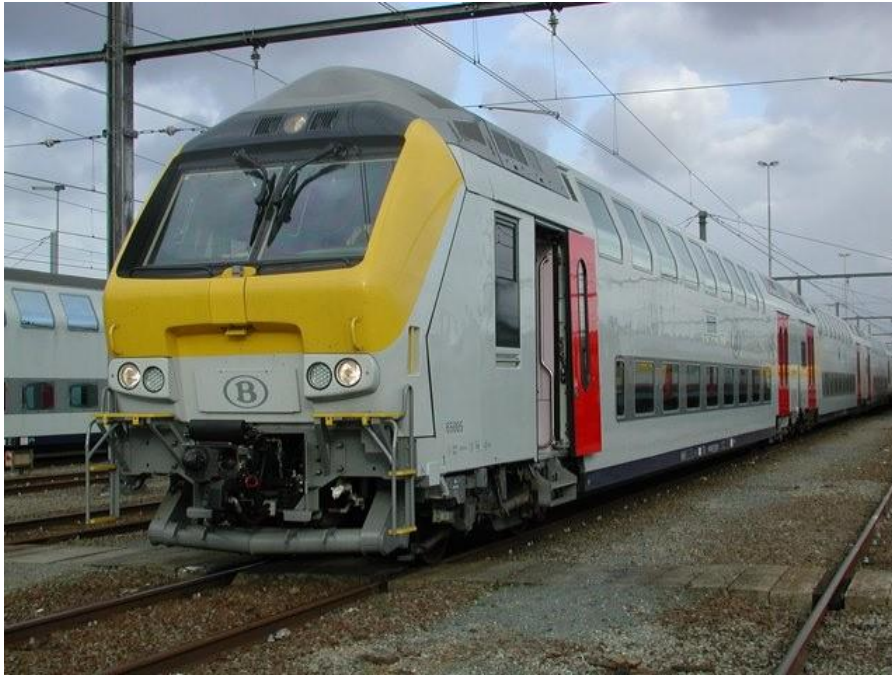
Stuurrijtuig M6 (dubbeldekrijtuig voorzien van een stuurpost)
