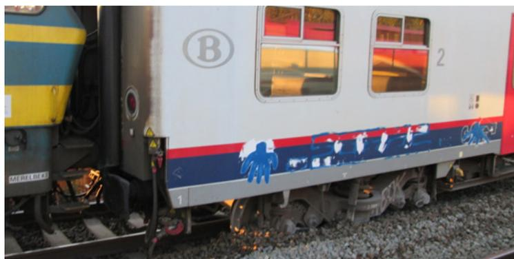
Cause : le déraillement a été causé par la vitesse excessive du train de voyageurs lors de son passage sur la liaison 11AD/11BD.
