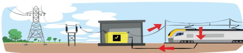
1. Les sous-stations de traction fournissent les tensions requises (tension continue 3 kV ou tension alternative 25 kV) aux caténaires.
