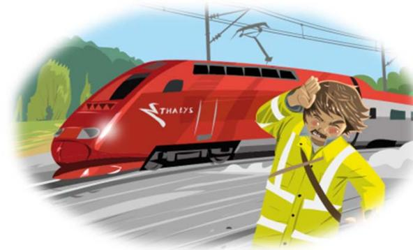
Film: Risque d'être déstabilisé par l'effet de souffle ou d'aspiration provoqué par le passage d'un mouvement.
