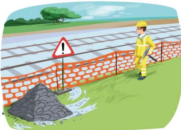
Lorsqu'un filet ou un treillis de sécurité orange (safety fence), est posé pour signaler la limite de la zone dangereuse, il ne peut en aucun cas être dépassé par des parties du corps, des machines, des outils ou des charges.
